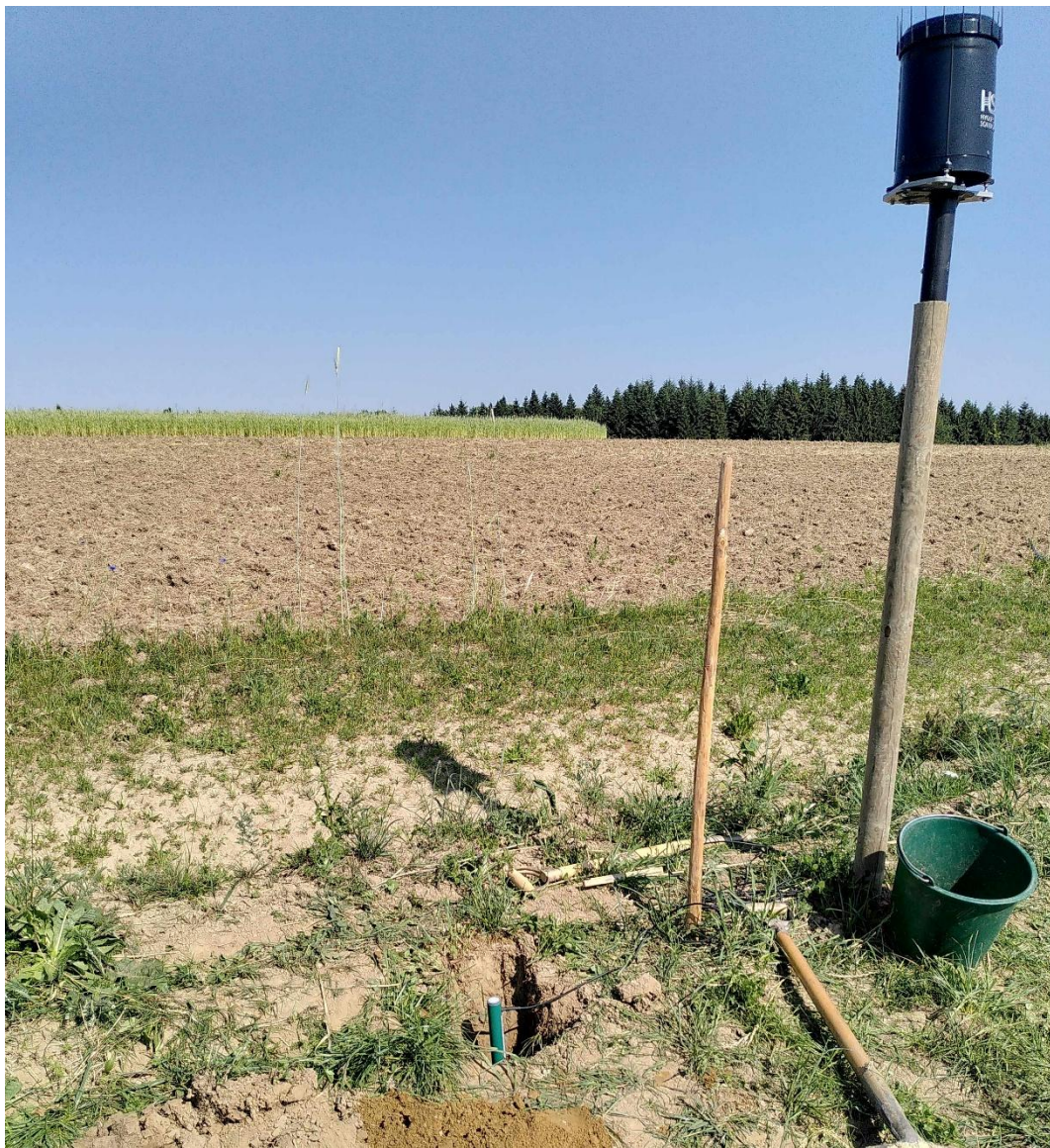
Installation Bodenmesssonde und Regensmesser, Juni 2023 Foto: NaturGut Katzhof
